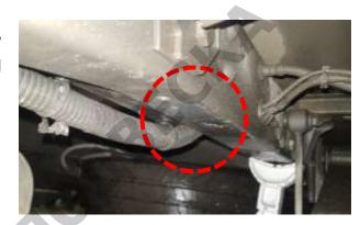
7. Установите подушки в сборе с кронштейнами на рессоры и закрепите их, притянув к рессоре стремянными болтами (см. фото).
