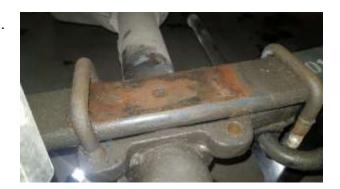
6. Демонтируйте штатные отбойники, установленные на раме автомобиля. И тщательно очистите места их крепления.
