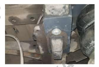
10. Установите левую и правую часть распорки на верхних кронштейнах (учитывайте маркировки сторон) используйте крепеж: потайные винты 7991 **10 30 (4 шт.)** и гайки с фланцем **6923 10 (4 шт.)**.
